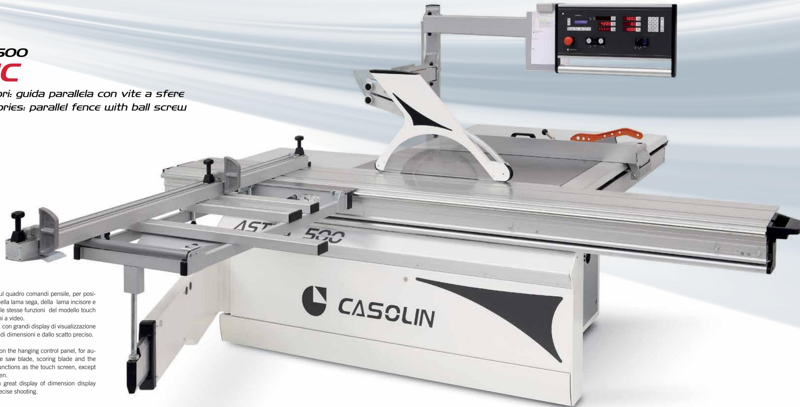
CNC 5 assi, a richiesta sul quadro comandi pensile, per posizionamento automatico della lama sega, della lama incisore e della guida parallela. Ha le stesse funzioni del modello touch screen, eccetto le funzioni a video.
