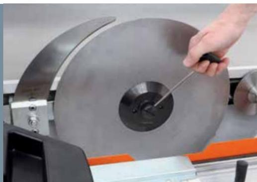
Sistema di fissaggio rapido della lama Easy-Fix.
