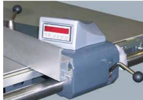
**Visualizzazione digitale delle misure sulla guida parallela.** Il display indica la misura al 1/10 mm. A richiesta (DGP).
