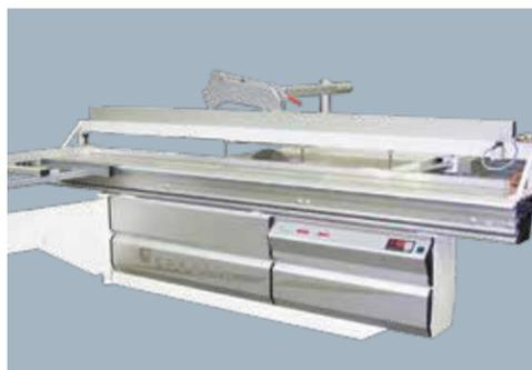
**Pressoio pneumatico** per il taglio di materiale plastico sottile o di impiallacciatura a pacchi (PPN).
